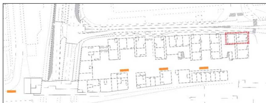
Eksempel på placering af affaldsstationer, storskraldsrum og vare- og affaldsgård til erhverv. — Affaldsstation ----- Storskraldsrum og vare- og affaldsgård i konstruktion
