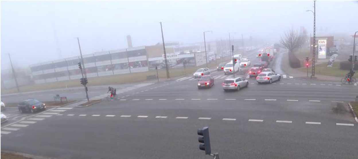
Figur 10. Eksempel på tilbagestuvning på Islevdalvej, hvor de venstresvingende fra Jyllingevej delvis spærre for udkørsel fra Islevdalvej.
