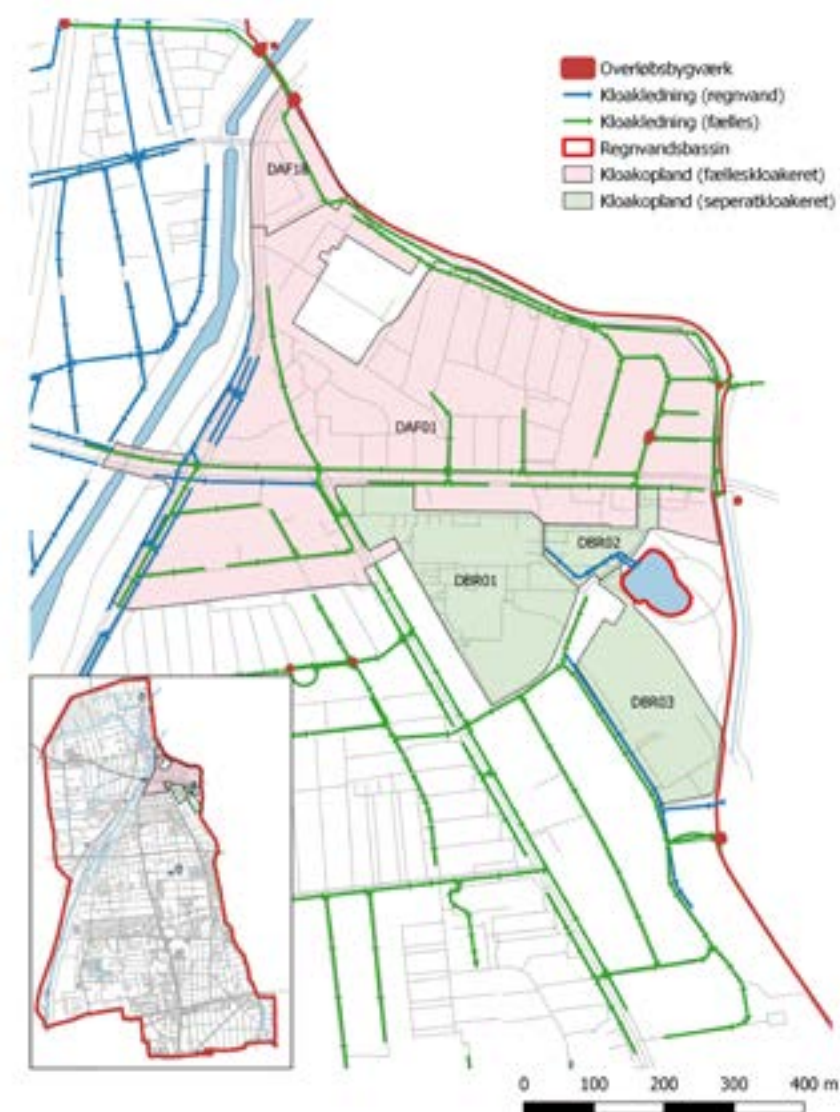
Figur 4.7 Deloplande omkring Islevbro Vandværk, Hovedopland D
