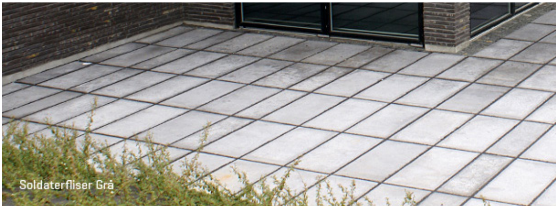
Soldaterflise fra IBF - På Hovedstrøget anvendes 4 forskellige flisestørrelser, henholdsvis de 2 standardstørrelser 45x90 cm og 90x90 cm samt 2 fliser med specialmålene 45x45 cm og 180x180 cm. Alle fliser skal dimensioneres til lejlighedsvis tung kørsel med en tykkelse på 10 cm og den store 180x180 cm flisen skal evt. forsynes med armeringsjern.
