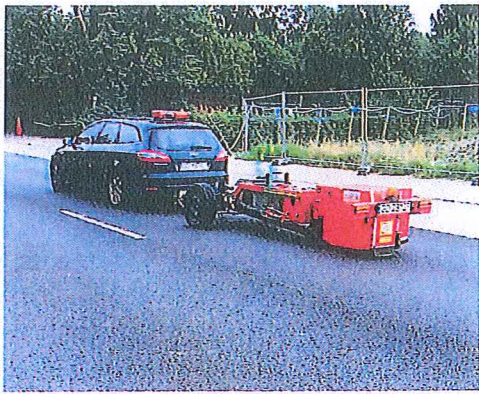
Figur 4. Rullemodstandsmåling med avanceret måletrailer fra T.U. Gdansk i Polen.
