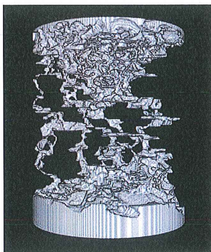
Figur 7. Hulrum, som giver flow fra top til bund, under antagelse af at vand ikke løber opad.
