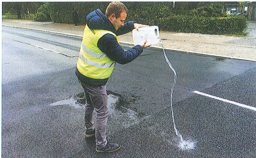
Figur 2. Forskel på rampe af tæt asfalt og permeabel testbelægning.
