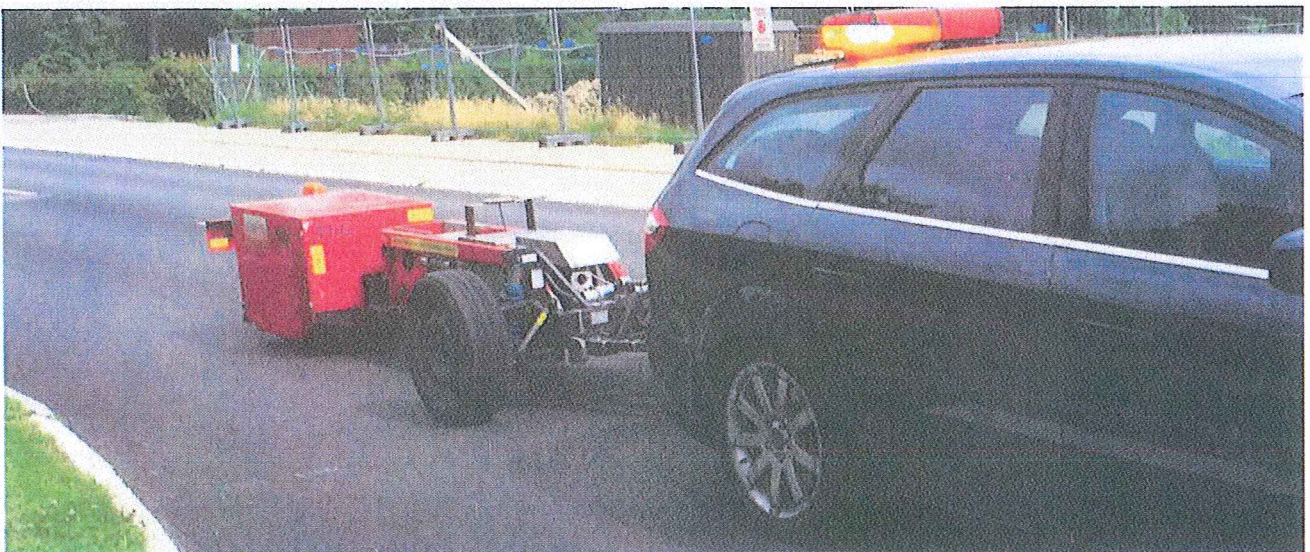
Måling af belægningens rullemodstand med specialudviklet måletrailer. Målingen dokumenterede, at belægningstypen trods den relativt grove overflade ikke vil forøge trafikens brændstofforbrug og CO 2 -udledning.
