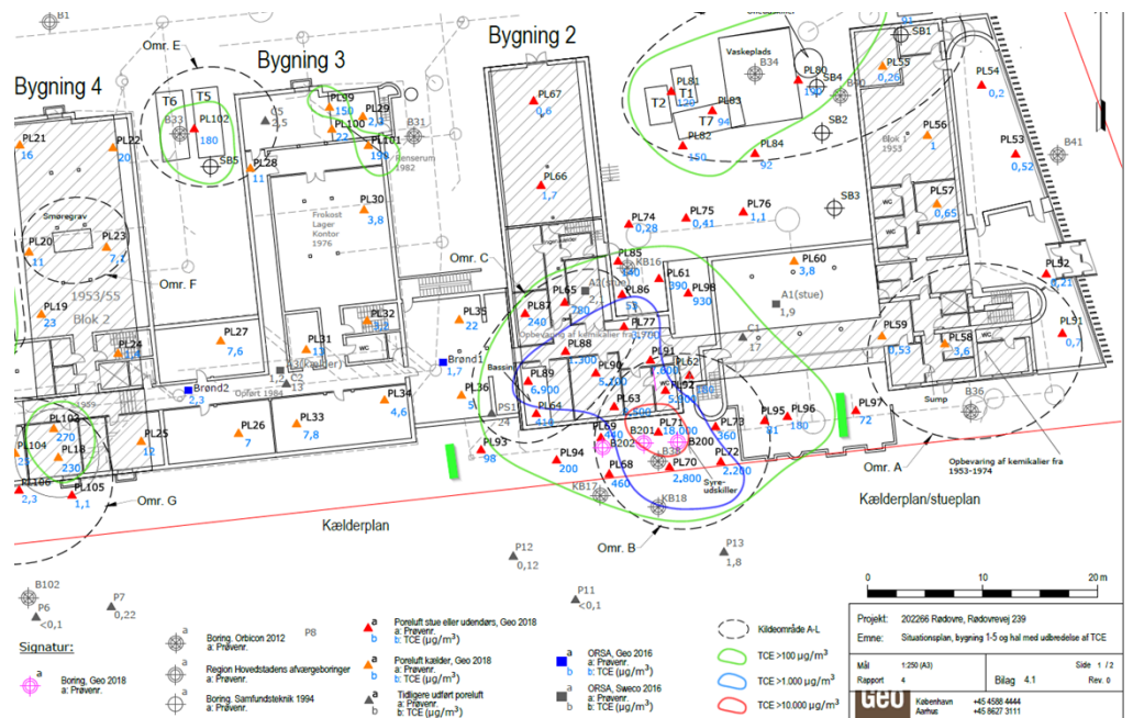
Fig. 4. Markering af kloakledning under hotspot syd for bygning 2. Ledningen løber mellem de to grønne streger.
