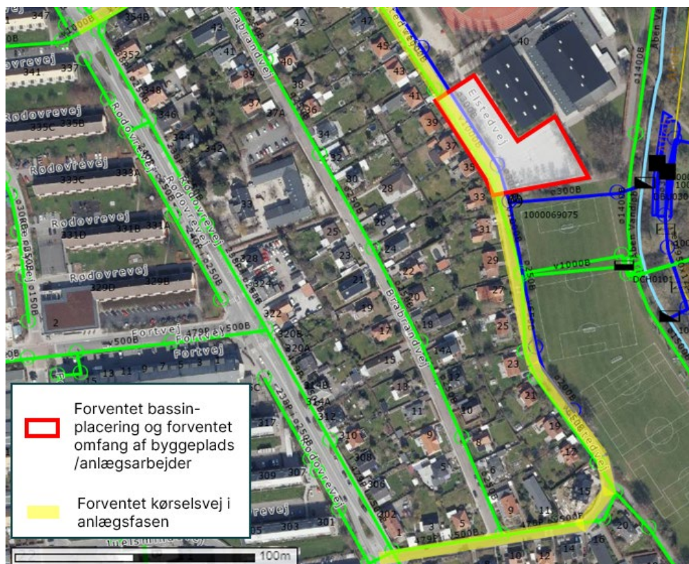
Figur 7 Reduktion af overløb ved Elstedvej. Bassinet placeres under P-pladsen ved stadion. Figuren er jf. projekttillæget til spildevandsplanen.
