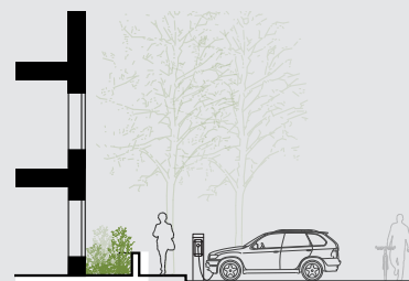
Principsnit ved kantzone med ladestander
