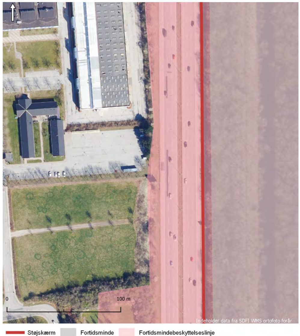
Figur 12-4 Støjskærmens placering i forhold til fortidsmindet og dennes beskyttelseslinje.
