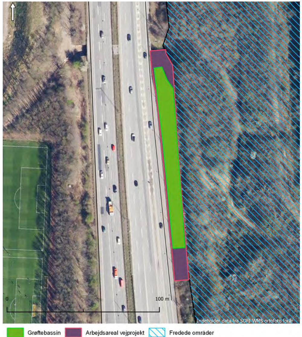
Figur 13-4 Grøftebassin ved fredning, arbejdsareal og bassin.
