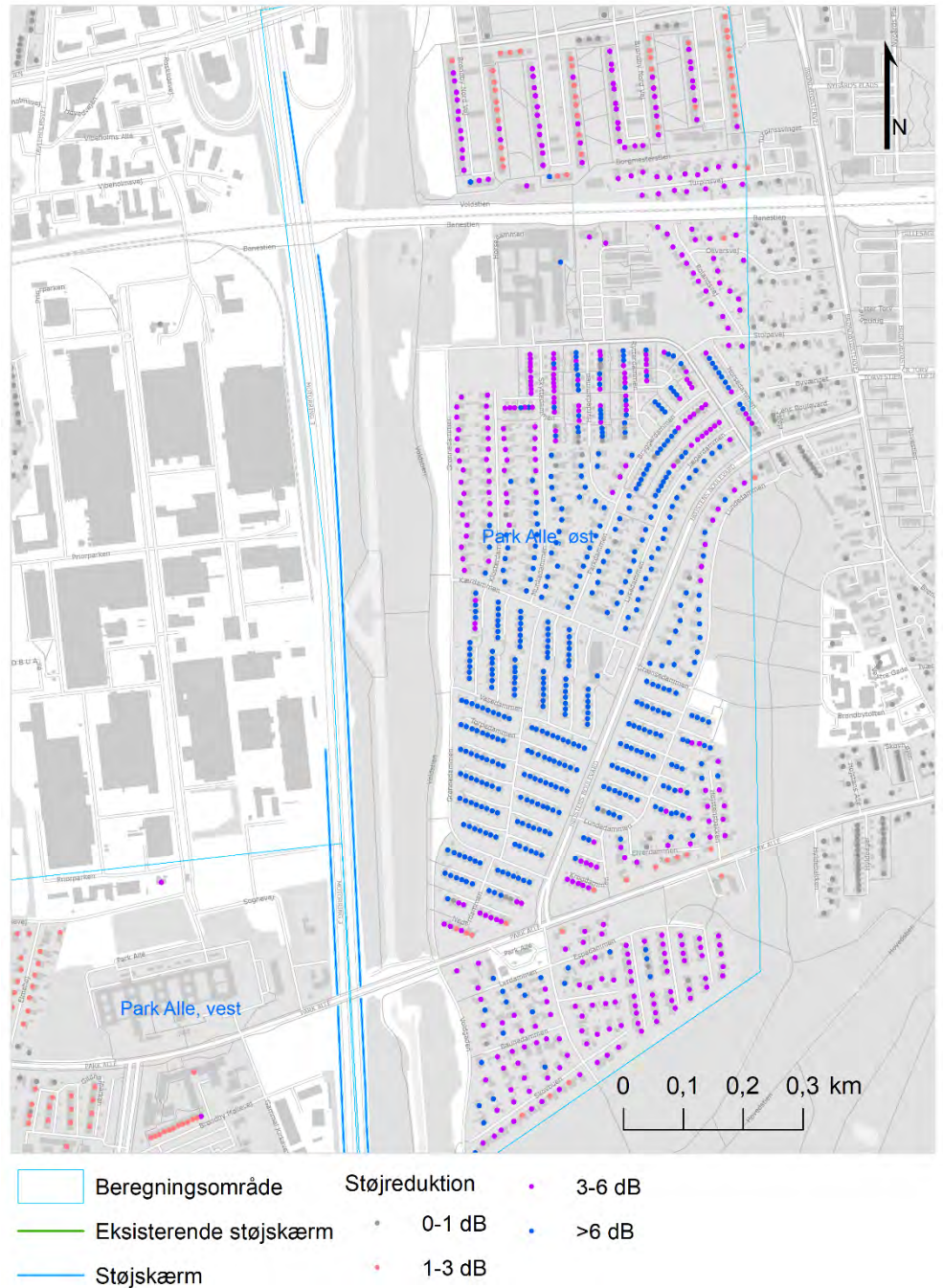
Figur 8-13 Beregnet støjreduktion ved boliger, der kan opnås med en 9 m høj støjskærmning.
