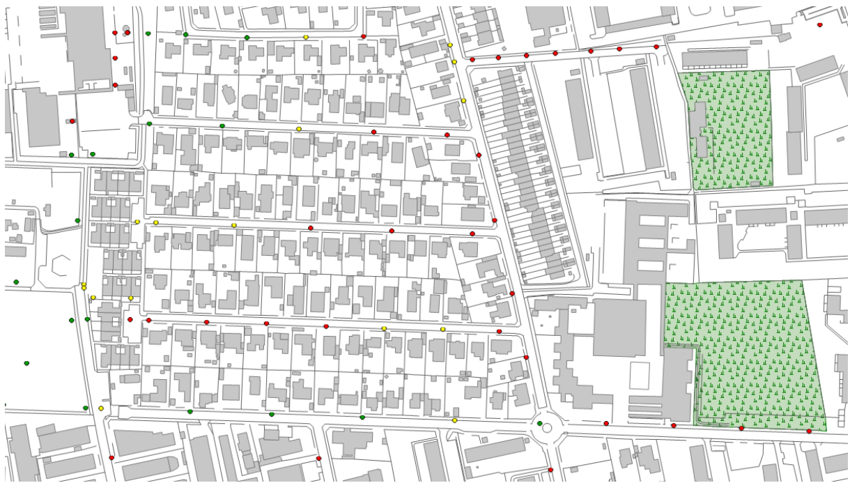
Figur 3. Serviceniveau ved T-5 i dag. Grøn viser brønde hvor stuvning på terræn ikke forekommer, Gul er der opstuvning i brønden, men ikke på terræn, Rød forekommer stuvning på terræn, men det vides ikke hvor meget.
